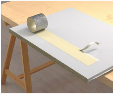
2. Mesurez le bord de la dalle + 10 mm de débord, puis décollez le papier de l'adhésif.
